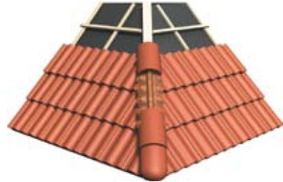
Kuva 15. Sisä- ja ulkotaitteissa on hyvä käyttää puolitiiliä, jotta välttäisiin pienistä leikatuista palasista jotka ovat hankalia kiinnittää.
