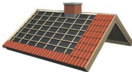
Kuva 6. Jatka kahdella- ja kolmella rivillä kohti harjaa. Tarkista, että rivit ovat suorassa. Tee tarvittaessa apuviivoja 1500 mm välein.
