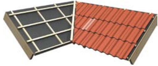
Kuva 14. Sisä- ja ulkotaitteissa on hyvä käyttää puolitiiliä, jotta välttäisiin pienistä leikatuista palasista jotka ovat hankalia kiinnittää.
