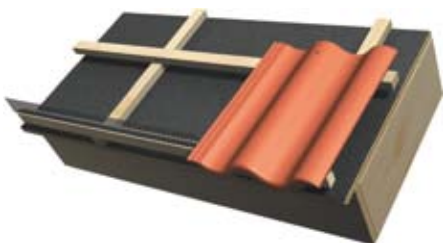
Kuva 13. Lintueste asennetaan sivuräystäälle.
