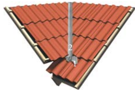
Kuva 17. Lappeelle päättyvä sisätaitte.
