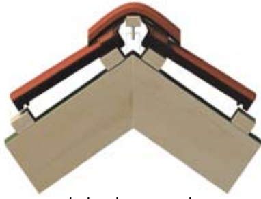
Kuva 8. Ilmava ja tehokas harjan tuuletus ja tiivistys.
