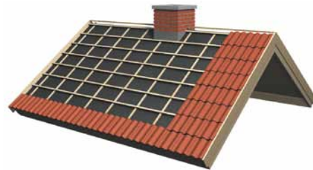
Kuva 6. Jatka ladontaa seuraamalla apuviivoja. Näin varmistat suorat tiilirivit.
