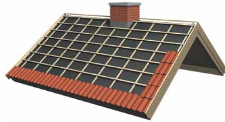
Kuva 5. Asenna ensiksi alin rivi oikealta vasemmalle. Sitten yksi rivi kohti harjaa. Tarkista, että tiilet ovat kohtisuorassa alimpaan riviin nähden.
