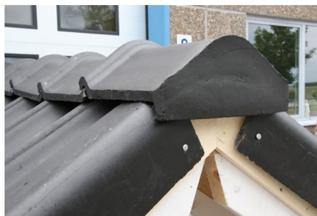
Monteringsbild 6. Anpassa höjden på nockbrädan så att nockpannan täcker över gavelbeslaget. Skjut upp sista gavelbeslaget så det överlappas av nockpannan. Detta medför att sista gavelbeslaget överlappar det underliggande något mindre. Komplettera eventuellt med en utsågad passbit för att täcka öppningen under slutnocken.
